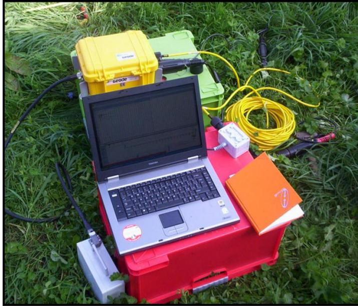
*Fig. 2 – Strumentazione utilizzata per le prove MASW.*
